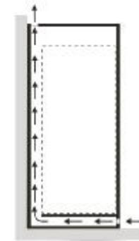
**Рисунок Б.4** - Схема циркуляції повітря навколо холодильного приладу
